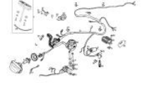
Conjunto de cables
